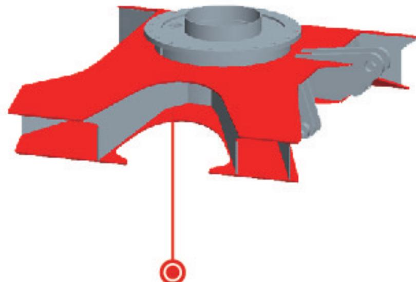
用支重轮代替托链轮，采用双边安装方式，改善了受力条件，结构更结实，托链轮寿命延长100%
