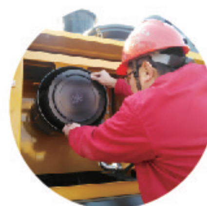
更换空气滤芯
