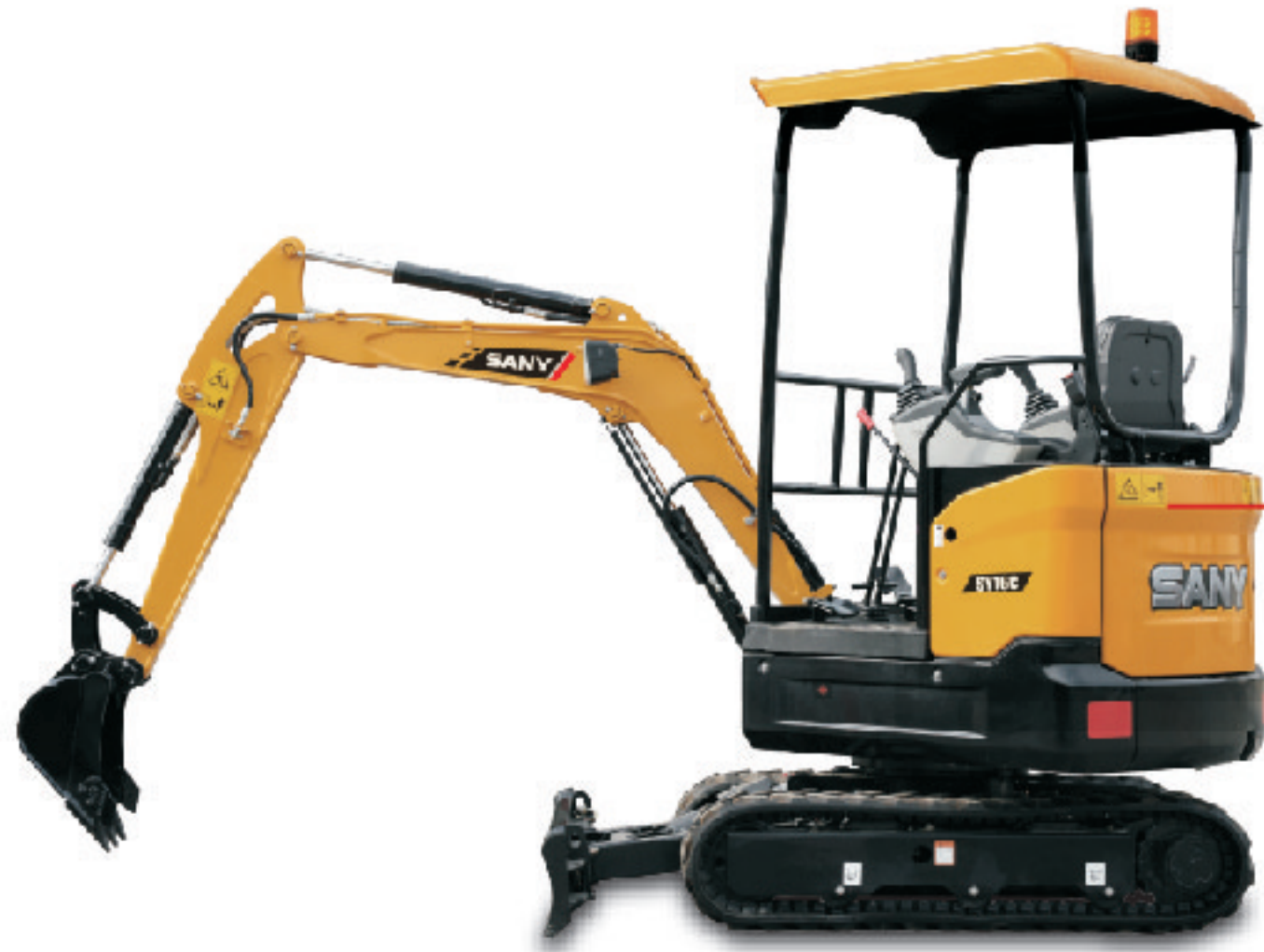
SY16C 采用金属覆盖件
